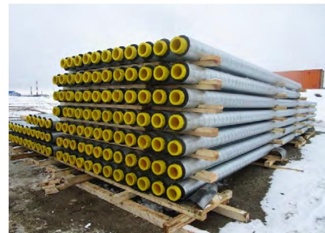
**МПТ В ТЕПЛОИЗОЛЯЦИИ**
