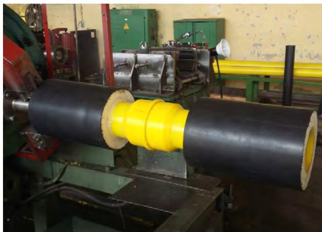
**МПТ В ТЕПЛОИЗОЛЯЦИИ**
